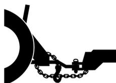
Ao acoplar o equipamento ao trator, utilize uma corrente para travar o cabeçalho do equipamento à barra de engate do trator. Esta medida evitará que as mangueiras hidráulicas venham a se romper ou o equipamento venha a empinar em caso de quebra do sistema de engate.
